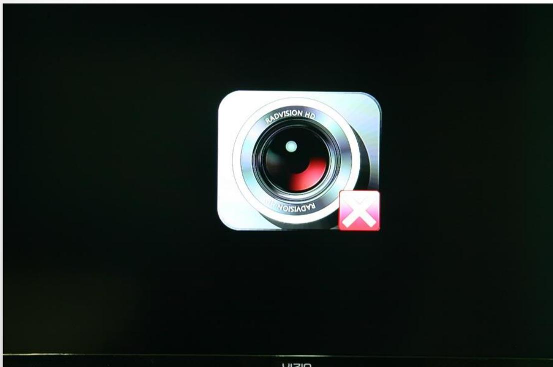
此畫面為設備開機時候進入選單前的測試畫面，如果停留超過三分鐘即表示攝影機 HD 1 / HD 2 / DVI 訊號異常。
